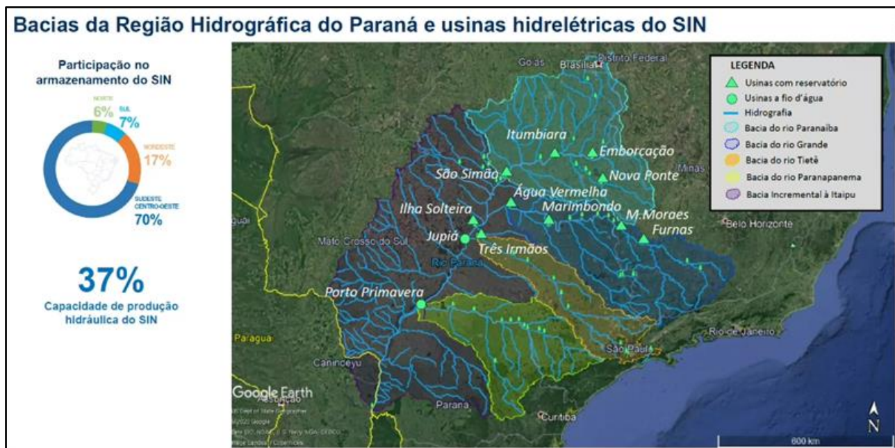
Figura 5 – Reservatórios do SIN na bacia do rio Paraná (Fonte: ONS).
