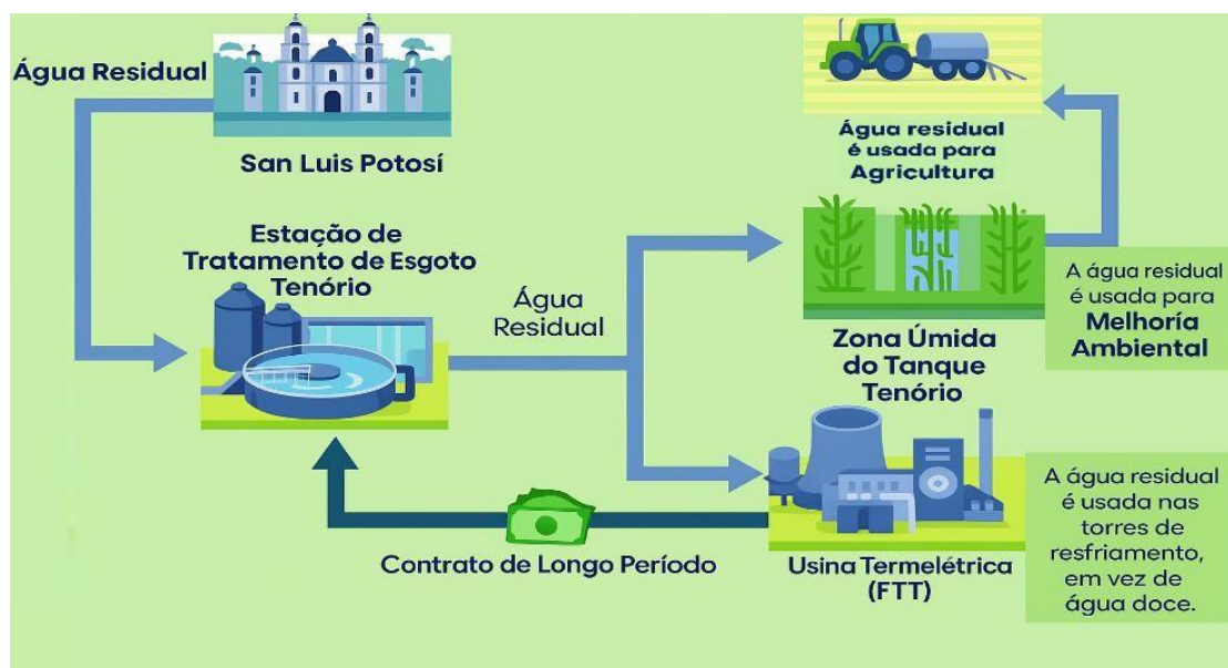
Figura 9 - Ciclo integrado de reúso de água: tratamento, geração de energia e agricultura
